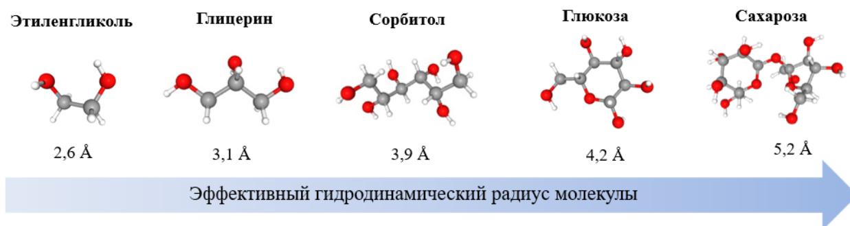
Рисунок 2.1 – Структура осмолитов, исследованных в работе, и их эффективный гидродинамический радиус [14]. Структуры представлены в виде шаро-стержневой модели: серым цветом показаны атомы углерода, красным – кислорода, белым – водорода.
